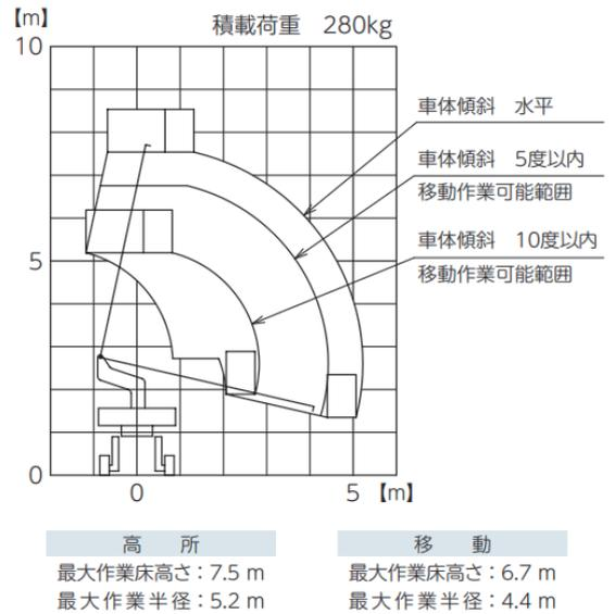
※車体傾斜により作業床高さ・作業範囲に規制が掛かります。
