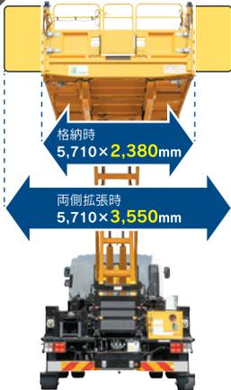
デッキスライドによる作床拡張で、車幅を超えての作業が可能。
