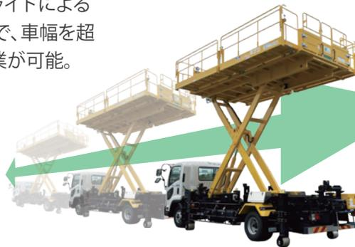
移動用ローラを装備したローラジャッキの採用で、デッキを上げたままの車両移動ができるため、連続した作業で威力を発揮。
