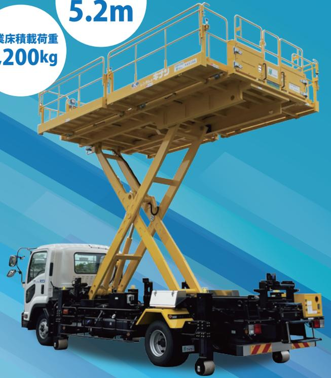
デッキに荷を積載したままの道路走行（運搬）とデッキを上げたままの車両移動が可能に。資材の積載・準備の時間を劇的に削減。
