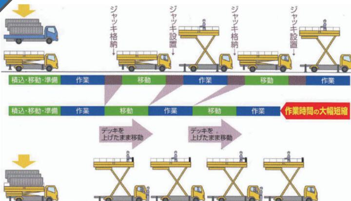
移動用ローラを装備したローラジャッキ採用。従来のような作業ポイント毎でのジャッキ設置・格納を行う必要がなく、作業効率が大幅にアップします。
