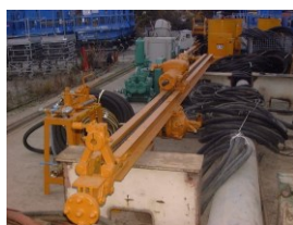
法面削孔機（吊り下げ式）
