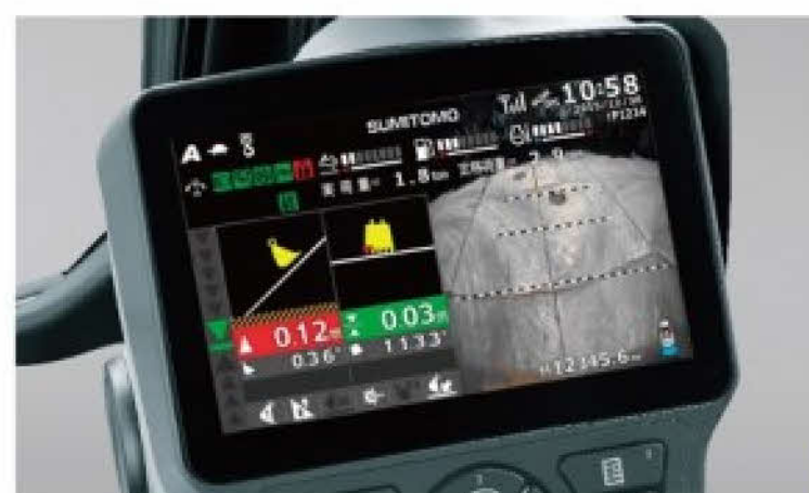
2DMGは機械のモニターでマシンガイダンスが可能 レバー部(2DMG用)
