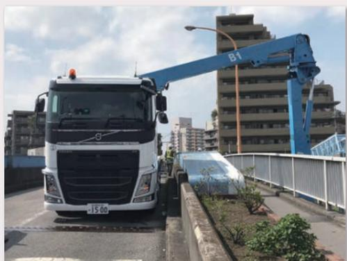
バーリンシリーズ共通の特徴であるアウトリガーその場張出。2.8mの占有幅で、一車線規制で作業が出来ます。アウトリガー張出幅による能力の減少がなく、マルチに活躍。
