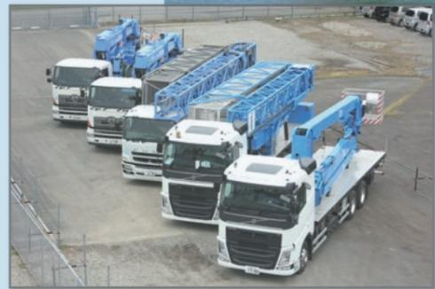
各拠点には国産のBT-400を始めとしたBT-200やBT-110の橋梁点検車や高所作業車の他、海外製の特殊な橋梁点検車も導入しております。
