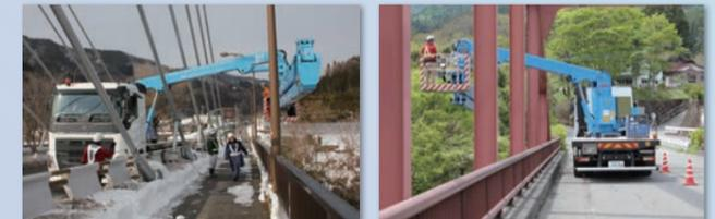
バケット式のAB1500及びAB1500Kは、展開時の自由度が高く、トラス橋や斜張橋・アーチ橋といった障害物のある現場でも適応出来ます。<sup>※3</sup>
