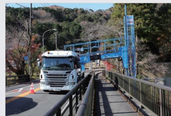
歩廊式の点検車で最大級の歩道対応能力。4mまでの歩道を跨いで作業することが可能です。当然アウトリガーも張らず、2.5m占有幅での作業が可能です。
