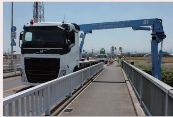
最大4mまでの歩道を乗越えて作業可能。BT-400は最大3.5mまでしか超えないため、作業を諦めていた橋梁で対応可能。既に多くの現場で採用頂いております。
