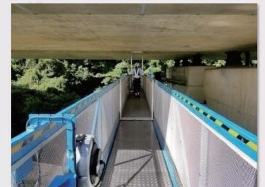
歩廊式のため、作業員さんが自由に桁下を行き来できます。BT-400等のバケット式に比べ、効率的に作業ができます。
