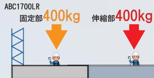
プラットフォームの積載量が通常の橋梁点検車よりも多くなっています。資材・人員をより多く載せることができ、橋梁工事の仮足場として使用頂けます。
