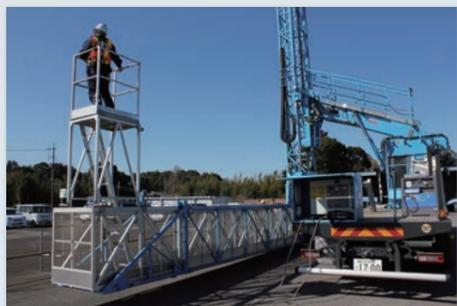
床高さ2.5mのアシストラダーを装着しております。床板までのアクセスが容易に。アシストラダーは歩廊内をスライドさせ位置を調整できます。
